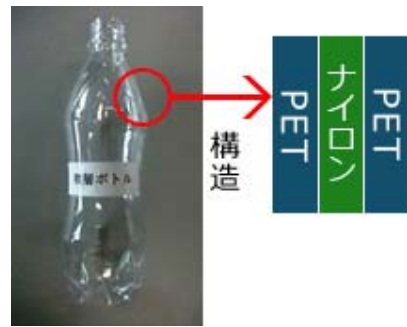
図1. 加温・炭酸飲料用PETボトルの構造
