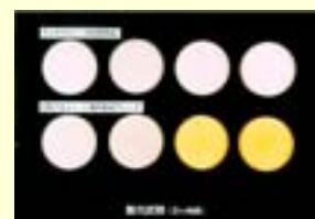
化粧品の原料の光安定性試験。 資生堂が用いるワセリン（上段）は、普通のワセリン（下段）と比べて、不純物が少なく、長時間強い光が当たっても変色せず安定です。
