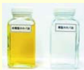
化粧品の原料であるホホバ油の資生堂使用品（右）と一般品（左）。色の明らかな違いからも、原料の精製により商品の品質が異なることが分かります。
