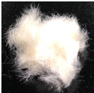
図 1 人工構造タンパク質 Brewed Protein™繊維を基にした化粧品原料
